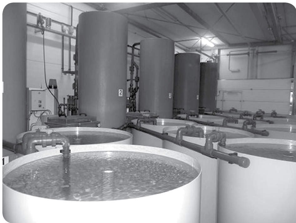
Experimentele recirculatiesystemen gebruikt voor onderzoek aan de microbiële gemeenschap in relatie tot visgezondheid bij IMARES.
